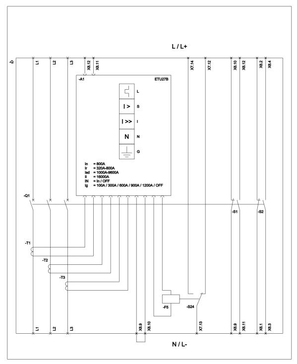
L (Long Time Delay / Überiastschutz); S (Short Time Delay / Kurzschlussschutz, kurzzeitverzögert); I (Instantaneous / Kurzschlussschutz, unverzögert N (Neutral Protection / Neutralleiterschutz); G (Ground Fault Protection / Erdschlussschutz); F5 (Maglatch for trip unit / Auslösemagnet); S1 - S8 (Auxiliary switch / Hilfsschalter); S24 (1st trip signalling switch K07 (Reset Position) / Erster Ausgelöstmeldeschalter K07 (Reset Position));
