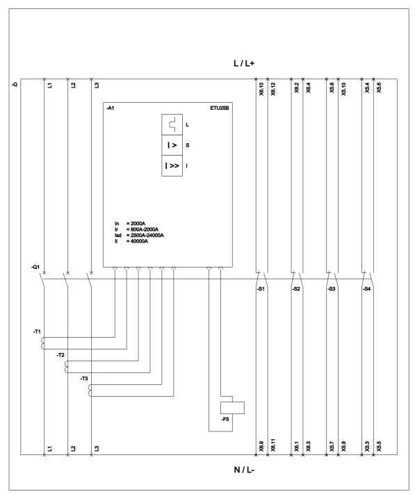
L (Long Time Delay / Überlastschutz); S (Short Time Delay / Kurzschlussschutz, kurzzcitverzögert); I (Instantaneous / Kurzschlussschutz, unverzögert); F5 (Maglatch for trip unit / Auslösemagnet); S1 - S8 (Auxiliary switch / Hilfsschalter);
